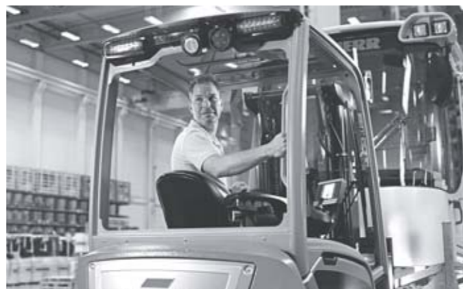
Assento giratório com vista para trás e possibilidade de segurar no manipulo
