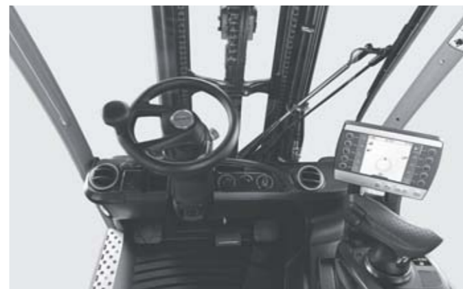
Espaço de trabalho com monitor e unidades de controlo, Joystick 4Plus e aquecimento
